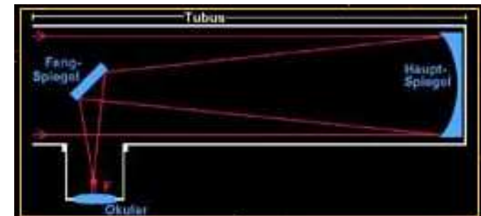
Bild 12: Das optische Prinzip des Newton-Spiegelteleskops
